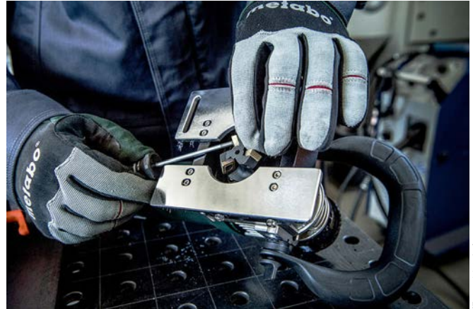
Bild 2 Die Metall-Planfräse PFM 17 erleichtert dem Anwender die Arbeit auf ganzer Linie – zum Beispiel lassen sich die drei Wendeplatten am Fräskopf einfach und bequem wechseln.
